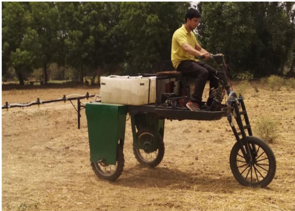
चित्र 1. गेहूँ की खड़ी फसल में तरल उर्वरक के छिड़काव के लिए विकसित स्वचालित मशीन का प्रोटोटाइप।
